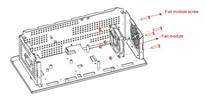
Figure 5-9 Removing the fan module
