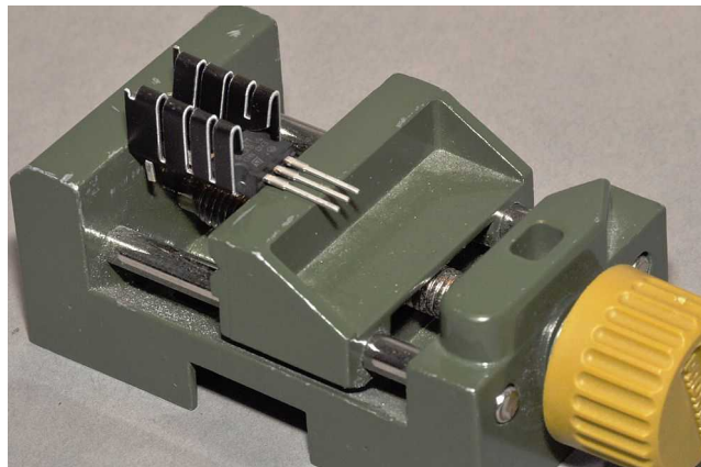
Spannungsregler in den Kühlkörper einschieben
